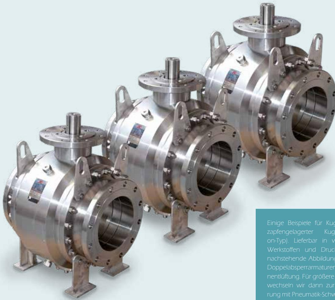
Einige Beispiele für Kugelhähne mit zapfengelagerter Kugel (Trunnion-Typ). Lieferbar in verschiedenen Werkstoffen und Druckklassen. Die nachstehende Abbildung zeigt einige Doppelabsperarmaturen mit Zwischenentlüftung. Für größere Durchmesser wechseln wir dann zur Automatisierung mit Pneumatik-Schwingenantrieb (Scotch-Yoke-Ausführung).
